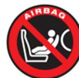
Sulla maggior parte dei modelli di veicoli l'airbag dell'accompagnatore può essere disattivato manualmente o automaticamente impiegando un seggiolino del costruttore del veicolo. In tal caso è possibile utilizzare un seggiolino rivolto in direzione contraria a quella di marcia anche sul sedile anteriore.
